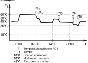
**35°C** Temperatura serbatoio di riscaldamento preventivo e mantenimento – valore dell'isteresi
